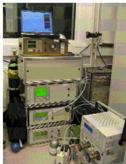
mobilni sistem za kontinuirno meritev emisije CO, NO, SO 2 , CO 2 , O 2 , TOC
