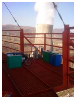
mobilni sistem za mokro vzorčenje; meritev SO 2 , H 2 O, HCl, HF, NH 3
